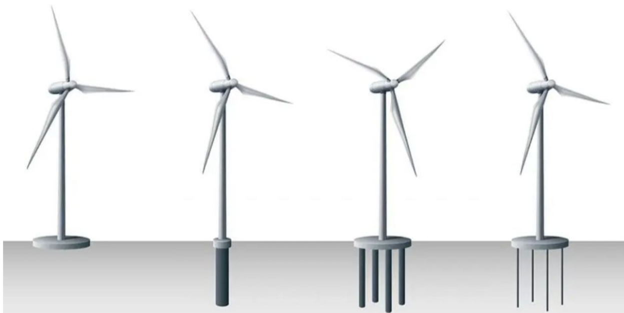
Joonis 2. Tuulikute vundamentide tüübid 3 . Vasakult gravitatsioonivundament, ühevaialine vaivundament ehk monovaivundament, plaatvundament kombineeritud vaiadega, plaatvundament kombineeritud ankrutega.
